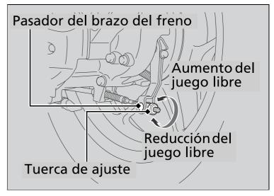
**2.** Accione el freno varias veces y compruebe si la rueda gira libremente al soltar la palanca del freno.
