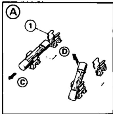
**ATTENTION:** Ne pas écarter les supports pour sortir un fusible, cela pourrait les déformer et causer un mauvais contact avec le nouveau fusible. Un fusible mal supporté peut endommager le circuit électrique et peut aussi causer un incendie.
