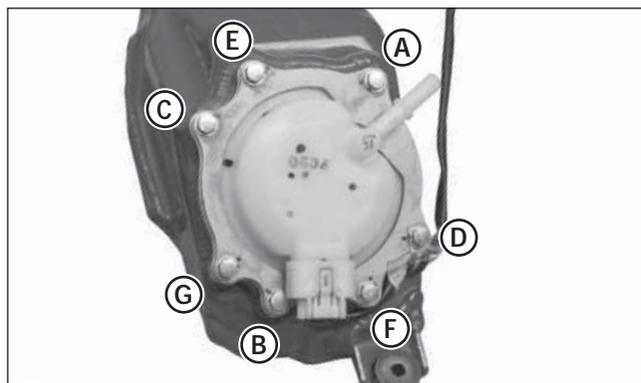
Installer les vis de montage de la pompe.
