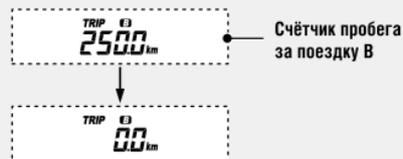
Предусмотрена возможность настройки автоматической функции сброса указателей резерва, пробега за поездку А, среднего расхода топлива и расхода топлива после заправки бака топливом, объем которого превышает резервный запас. Режим автоматического сброса указателей при заправке топлива можно включать и выключать.
