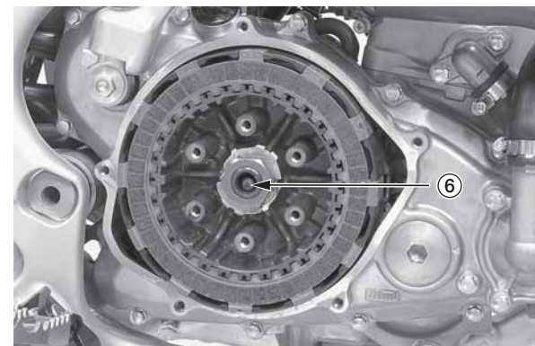
(6) шток толкателя сцепления
