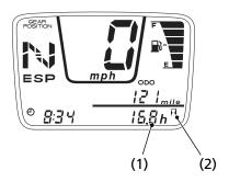
(1) hour meter (2) hour meter mark
