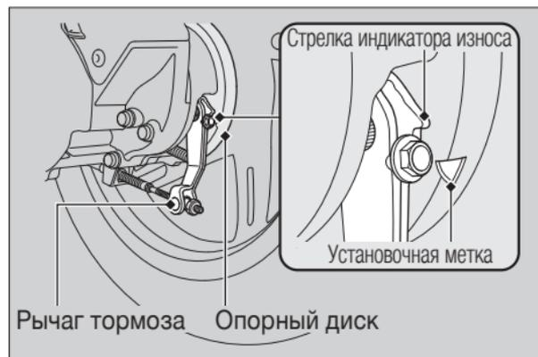
При торможении стрелка индикатора износа сдвигается в сторону метки на опорном диске. Тормозные колодки необходимо заменить, если стрелка индикатора износа находится на уровне метки при нажатии на тормоз до упора.
