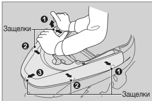
2. Расщелкните защелки задней панели наружной обшивки от передней части панели к задней. При этом придавливайте панель так, как показано на рисунке.
