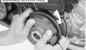
CLUTCH/DRIVEN PULLEY ASSEMBLY
